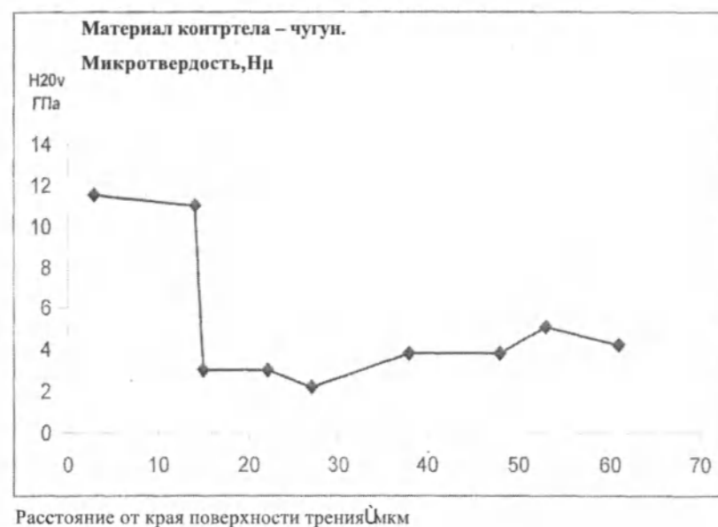
Рис. 4. Изменение микротвердости покрытия в поперечном сечении после испытания на износ по чугуну ( v = 6,5 м/с).
