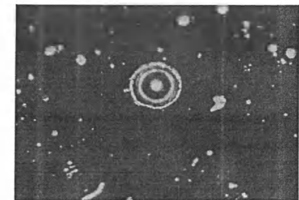
Рис. 2. Микрошлиф частицы эрозии латуни в этаноле. (Оптическая микроскопия, увеличение x500).
