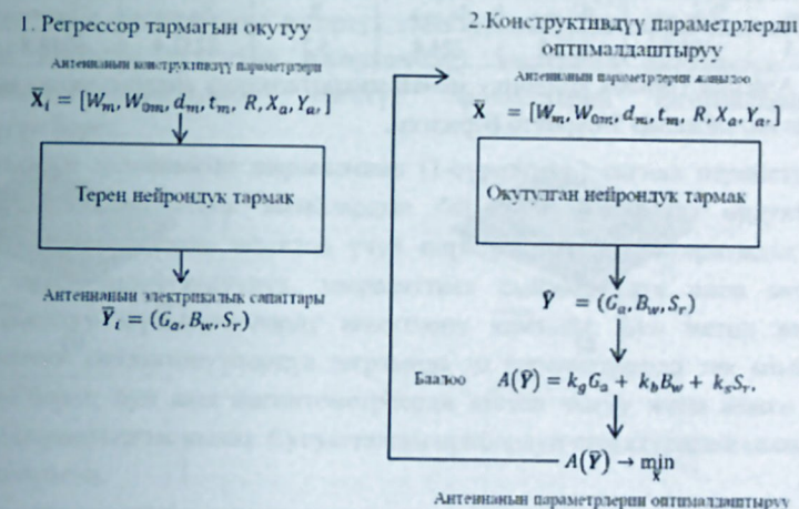
4-сүрөт – Микротилкелүү антеннанын CSRR клеткаларынын оптималдуу конструкциясын издөө схемасы
