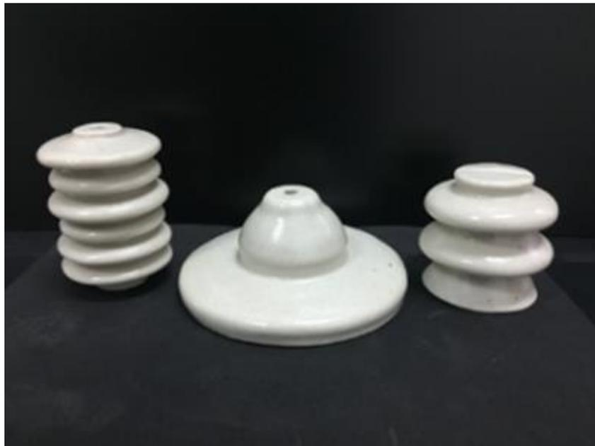
Рис.5. Глазурованные полупромышленные изделия ВФК после корректировки состава глазури.
