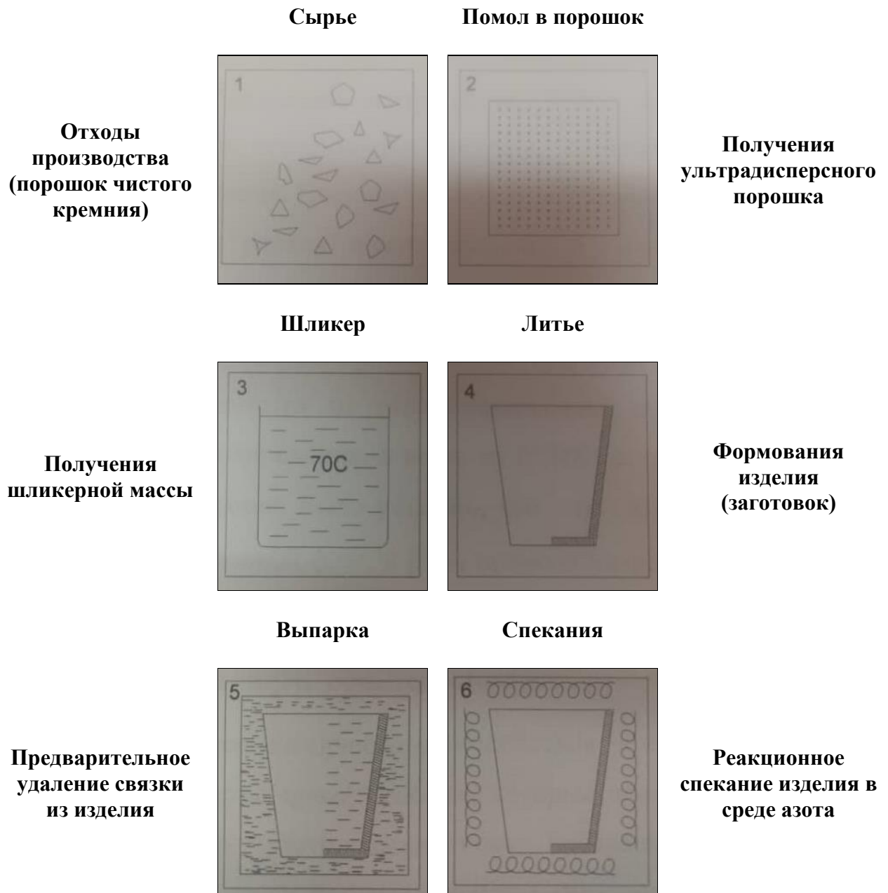
Рис. 1. Технологические процессы получения нитридо-кремниевых материалов методом реакционного спекания в среде газообразного азота.
