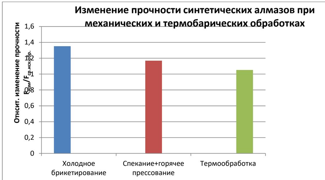
Рис. 2. Результаты измерения  $F$  для алмазов АС100
