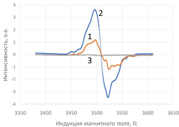
Рис. 2 – ЭПР – спектр облученного образца пробирки (1) в сравнении со спектрами ЭПР лавсана (2), облученного дозой 100 кГр и необлученной пробирки (3)
