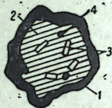
Рис. 6. Зарисовка миндалины в трахиандезито-базальте: 1 — хлорит; 2 — натролит; 3 — апатит (призматические сечения); 4 — апатит (гексагональные сечения).
