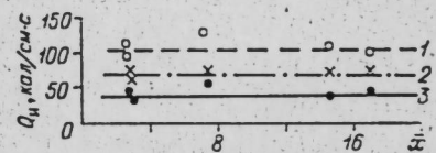
Рис. 2. Распределение лучистого теплового потока вдоль канала. d=1,0 см; G=15 г/с; \bar{a}=22,1 ; g_1=0,7 г/с; I=150 А (1); 120 (2); 90 А (3).
