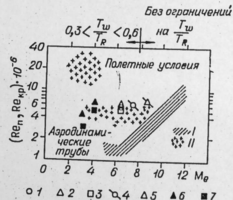
Рис. 5. Влияние числа Маха M_\infty над поверхностью и единичного числа Рейнольдса \frac{\rho_e v_e}{\mu_e} 1/м на переход пограничного слоя на конусах [2]; \frac{T_w}{T_R} \approx \frac{T_w}{T_\phi} ; 1—5 — № опытов в ИТ-301 (см. таблицу); 6—7 — данные для пластины [3]; 6 — труба Т-313; 7 — труба Т-325.
