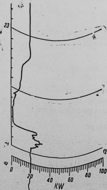
Рис. 1. Колебание мощности резания в зависимости от физико-химических свойств природного камня.
