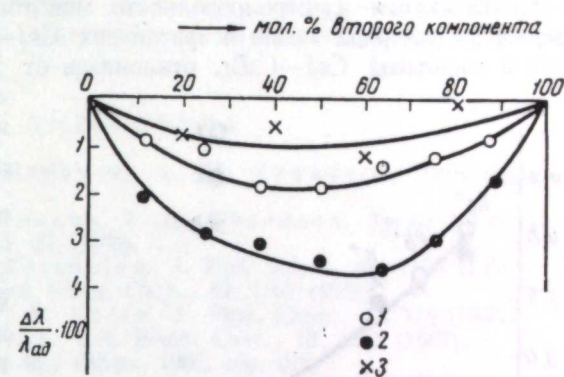
Рис. 2. Относительные отклонения эквивалентной электропроводности при 1070° К от аддитивно рассчитанных величин для расплавленных смесей.
