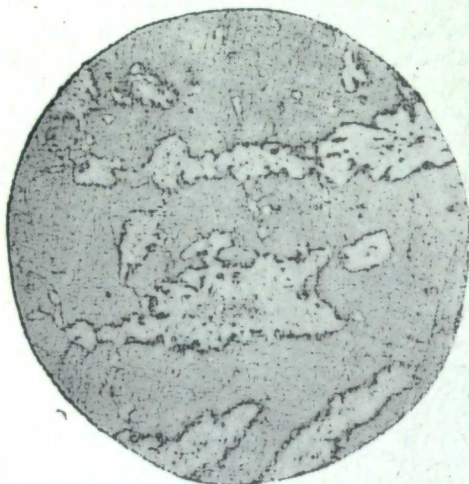
Рис. 3. Микрофотография сплава Al—Mn, содержащего 55 ат. % Al, отвечающего гетерогенной области ( \beta+r )-фаз. Светлое — \beta -фаза, серое — r -фаза. Травлено: концентрированная HCl. \times 200 .
