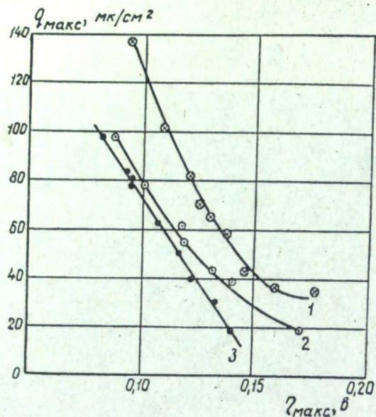
Рис. 3. Зависимость количества электричества, необходимого для зарядки электрода до q_{\text{макс}} . 1 — 16, 2 — 3, 3 — 0 вес.% \text{UCl}_4 .
