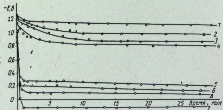
Рис. 4. Поляризация танталового анода во времени при следующих условиях:
