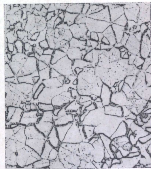
Рис. 10. Шлиф продольного сечения осадка, обладающего двойниковой структурой.
