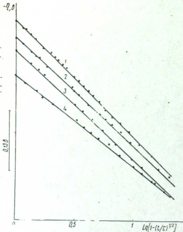
Рис. 3. Обработка экспериментальных кривых по уравнению (18). C_{Ag} = 10^{-4} \text{ мол/см}^3 .
