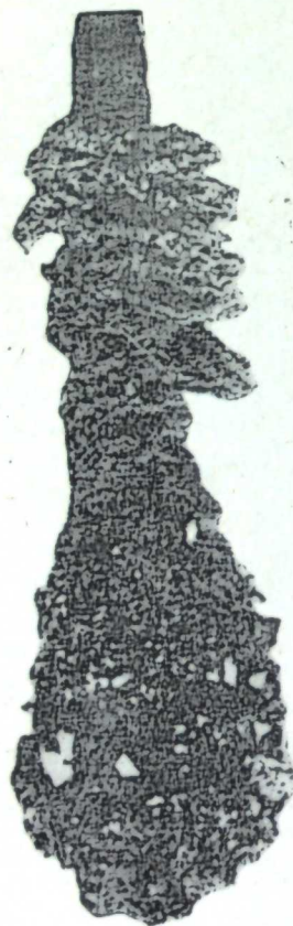
Рис. 3. Катодный осадок, полученный из йодидного электролита.
