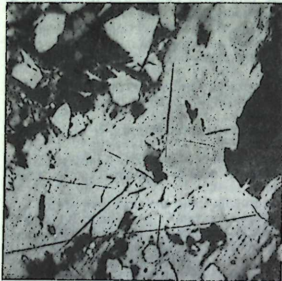
Рис. 3. Висмутин (серый) в ассоциации с пиритом (белый); нерудная масса (черная). Полированный шлиф. Увел. 156.
