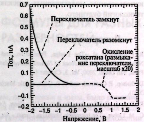
Рис. 13.22. Вольтамперные характеристики молекулярного переключателя, изображенного на рис. 13.21.
