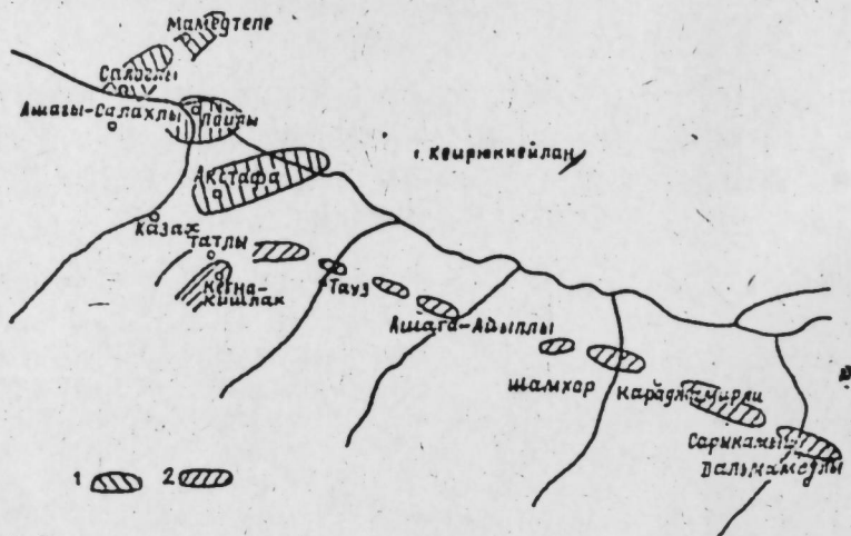
Рис. 1. Схема расположения поднятий по юрскому структурному этажу: 1—поднятия, выявленные гравиразведкой; 2—поднятия, выявленные сейсмразведкой.
