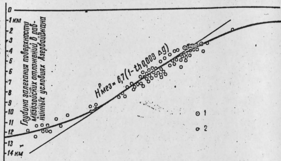
Рис. 1. Корреляционный график зависимости гравитационного поля от глубины залегания мезозойских отложений: 1—данные глубокого бурения пл. Джарлы; 2—данные ГСЗ, КМПВ и МТЗ. Составили С. Мамедов, К. Керимов
