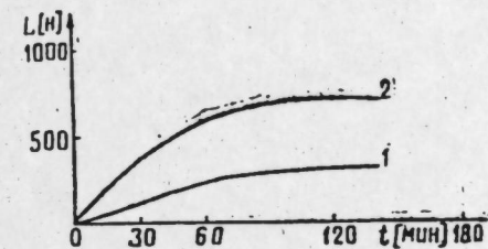
Рис. 4 Зависимость проникновения для статического и динамического струйного разрушения породы от времени: D_0 = 4 мм, P_{\max} = 250 ат, P_{\min} = 150 ат, T_n = 1/60 сек, порода—гранит; 1—струя постоянного давления P = \frac{P_{\max} + P_{\min}}{2} ; 2—струя переменного давления P_{\max} и P_{\min}
