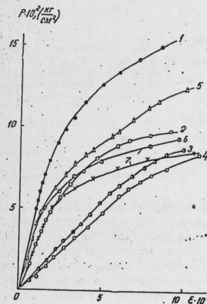
Рис. 1. Истинная диаграмма напряжение—деформация для монокристаллов Cu_{2-x}S
