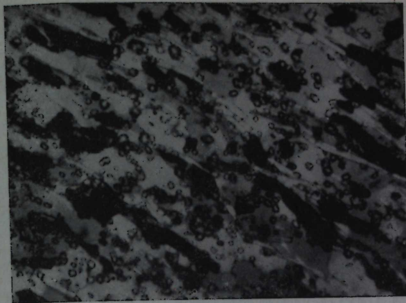
Рис. 6. Гематитовый гондит Западно-Иткульского рудопоявления. \times 220 , ник. П. Черное — гематит; светлое и серое — кварц; рельефные зерна — гранат; удлиненные — мусковит, хлорит.
