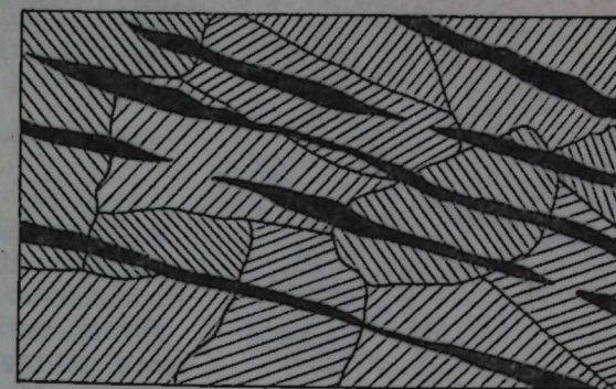
Рис. 7. Развитие магнетита в гиперстените вдоль трещин кливажа раскола, рассекающих различно ориентированные зерна гиперстена. Обр. 4862 н , месторождение Радостное.
