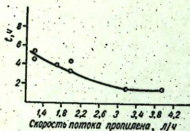
Рис. 4. Зависимость времени появления максимальной адсорбции пропилена от скорости потока пропилена (при изменении соотношений скоростей газа-носителя — азота и пропилена от 1 : 1 до 1 : 13). (T = 350°, катализатор II).
