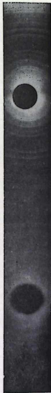
Рис. 1. Рентгенограмма высушенной при 100°С фосфорнокислой соли тантала.
