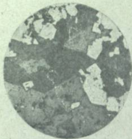
Фиг. 31. Идиморфный кристалл кварца (темносерый в форме ромба) среди сфалерита (светлосерый). Внутри кварца виден сфалерит. Пирит (белый с рельефом) идиоморфен по отношению к кварцу. Тонкая коллоформная оболочка пирита пересекает сфалерит и кварц. Сибирь, скважина № 97, глубина 197 м \times 180.
