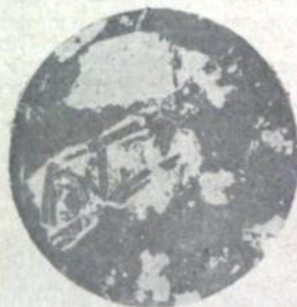
Фиг. 18. Отрицательные псевдоморфозы пирита по какому-то микролитовому минералу (плагноклазу?). Общая структура руды имеет вид замещенного туфа. Черное — кварц, белое — пирит. Сибай, скважина № 101, глубина 46,8 м. \times 150 .
