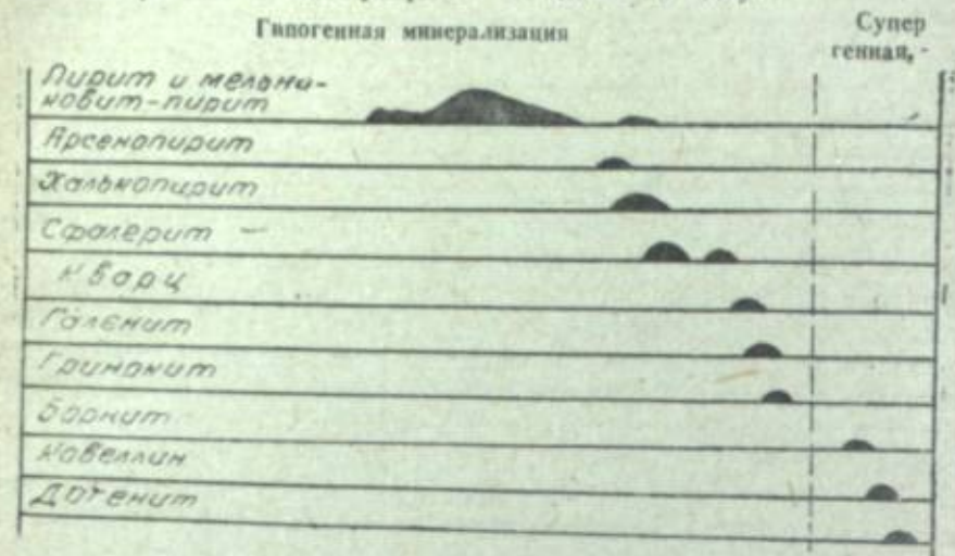
Фиг. 36. Возможная схема последовательности образования минералов в рудах верхней части Сибайского месторождения.
