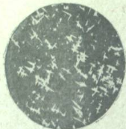
Фиг. 34. Характер выделений галенита (белый) в кварцевой жилае, рассекающей колчедан. Черное—кварц. Сибай, скважина № 101, глубина 23 м. \times 1000 .
