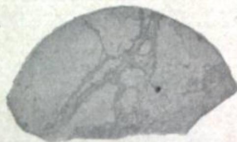
Фиг. 25. Полированный штаф колчедана с жилками сфалерита (черные). В средней части жилок виден тонкозернистый пирит. Сибай, скважина № 153, глубина 230 м \times 1 .
