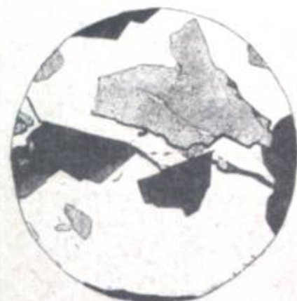
Фиг. 24. Идиоморфные выделения сидерита (черный) в халькопирите (белый), соединенные между собой тонкими жилками. Сидерит проникает также по нижней границе зерна магнетита (серый). Сибай, скважина № 128, глубина 252 м \times 350 .
