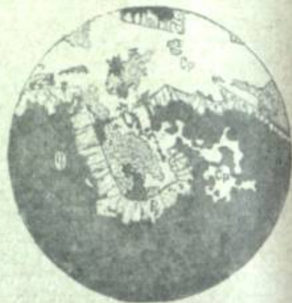
Фиг. 9. Псевдоморфозы дисперсий пирита, частично замещенные в свою очередь халькопиритом и сидеритом. Белые с мелкими точками — дисперсия пирита, белое (Ср) — халькопирит, черное внутри псевдоморфоз — сидерит, белые венчики (Pу) — пирит; черный фон (q) — кварц. Тот же шлиф, что и на предыдущей фигуре. \times 120 .
