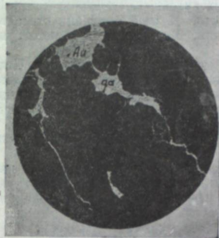
Фиг. 1. Выделения золота по трещинкам в кварце. Среди золота зерно галенита. \times 100 .
