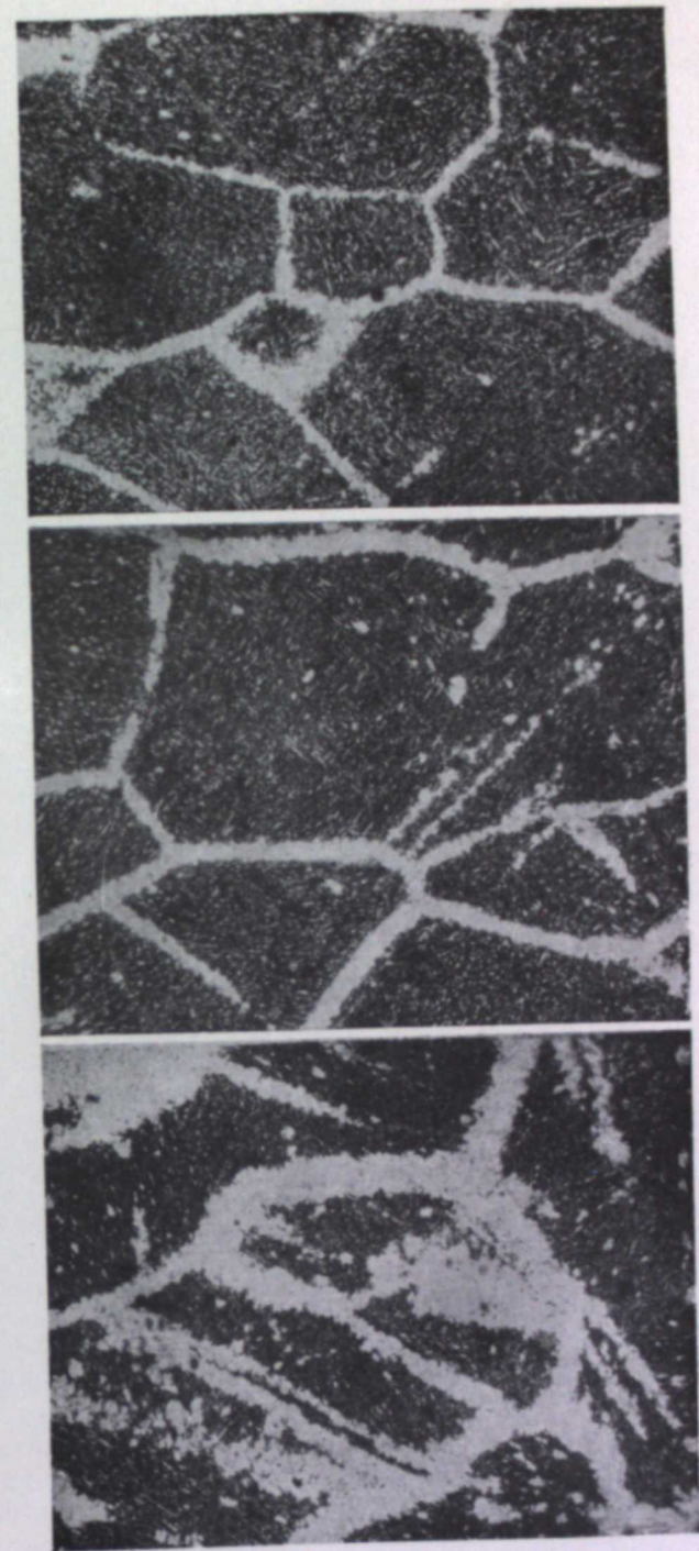
Фиг. 15. Микроструктура средней части клиновидного образца стали 35ХГСА после термомеханической обработки при 900° (с подстуживанием от 1250°) и градиентного электронного нагрева со скоростью 100—200°/сек.:
