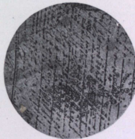
Фиг. 5. Микроструктура стали 20Г12Н8 после закалки от 1150° в воде и испытания на удар при температуре — 100° (вблизи излома). \times 740 .
