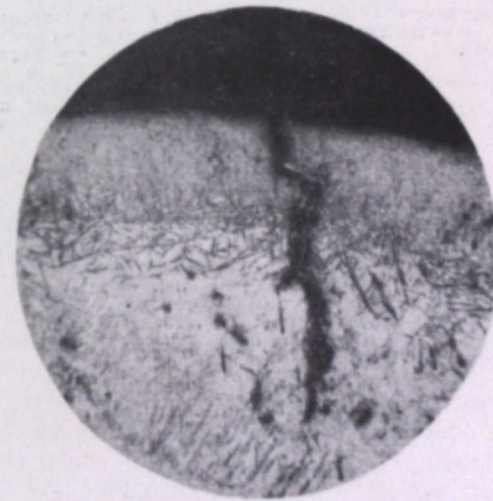
Фиг. 17. Радиальные трещины на поверхности закаленного от 1150^{\circ} образца стали 80XН12, подвергнутого перед охлаждением в жидком азоте отпуску на 450^{\circ} . \times 35
