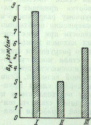
Фиг. 14. Ударная вязкость отпущенных поперечных образцов стали 35ХГСА:
