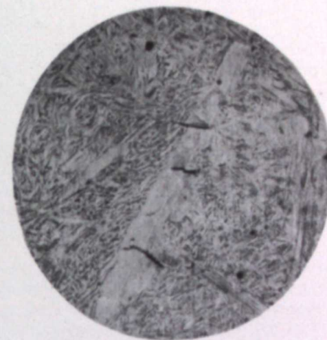
Фиг. 5. Микротрещины в закаленной углеродистой стали У12. \times 740 .
