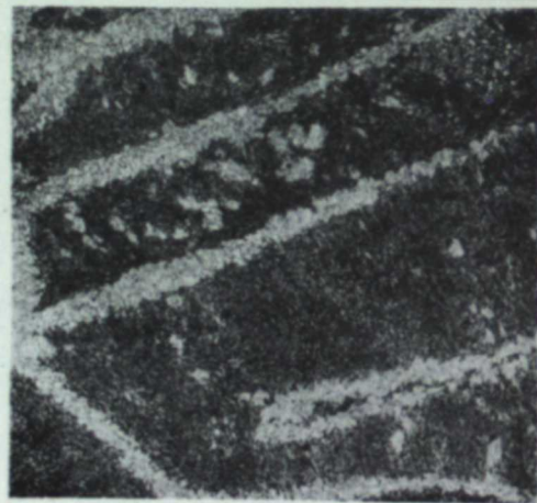
Фиг. 16. Микроструктура средней части клиновидного образца стали 35ХГСА после термомеханической обработки с обжатием 30%: а — увелич. 60; б — увелич. 450; в — увелич. 675.
