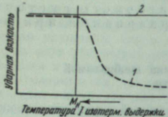
Фиг. 23. Схема ожидаемого изменения ударной вязкости в зависимости от температуры первой изотермической выдержки:
