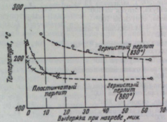
Фиг. 8. Влияние исходной структуры и продолжительности нагрева на положение мартенситной точки стали ШХ15.
