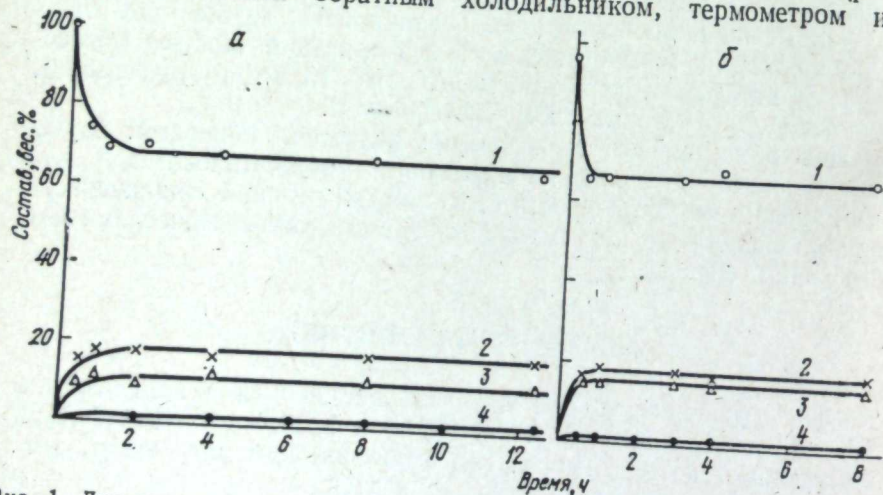
Рис. 1. Диспропорционирование 1,2,4,5- (а) и 1,2,3,5-тетраметилбензола (б). — тетраметилбензолы; 2 — пентаметилбензол; 3 — триметилбензолы, 4 — ксилолы и гексаметилбензол.
