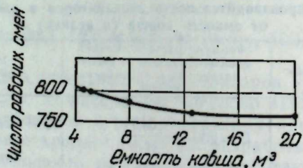
Рис. 2. Зависимость числа рабочих смен в году от емкости ковша
