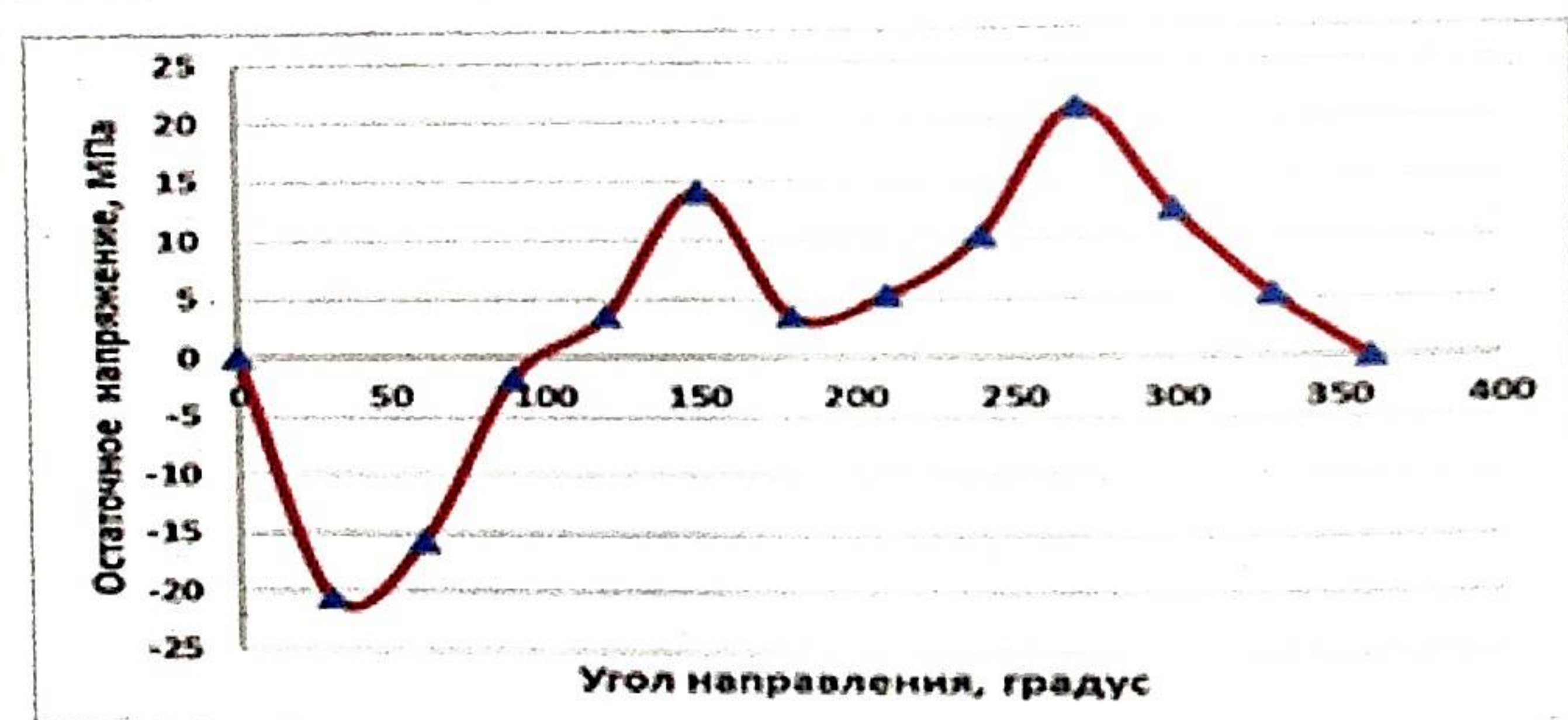
График остаточных напряжений для разных направлений, проба F – 11b–1, образец 3, р. Кумтор (уступ 4230, темно-серый, черный филлит с кварц карбонатными прожилками).
