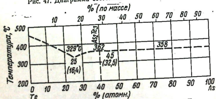
Рис. 48. Диаграмма состояния системы As — Te AsTe 3 (71,87% Te). Соединение As 2 Te 3 имеет моноклинную решетку с периодами a=14,4 \text{ \AA} ; b=4,05 \text{ \AA} ; c=9,92 \text{ \AA} ; \beta=97^\circ [185].
