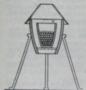
Рис. 18. Прибор для получения FeS.
