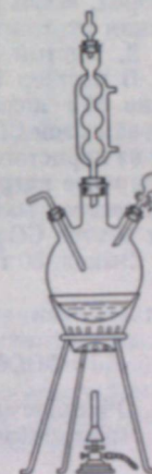
Рис. 61. Прибор для получения трехбромистого фосфора.
