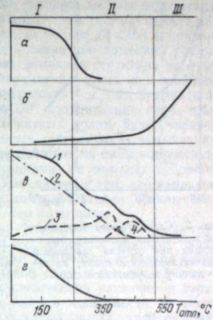
Рис. 2. Схематическое изображение процессов, происходящих при отпуске закаленной простой углеродистой стали.
