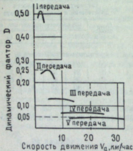
Рис. 52. Динамическая характеристика автосамосвала МАЗ-525.
