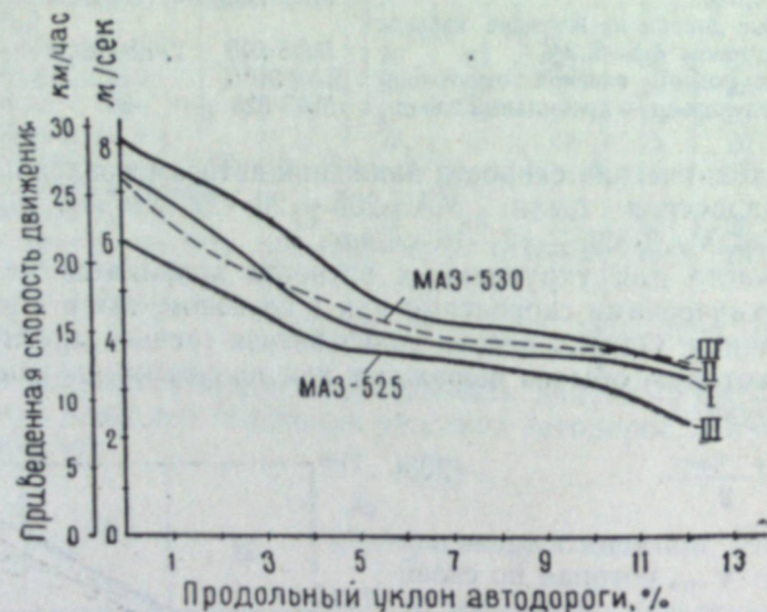
Рис. 60. Зависимость приведенных скоростей автосамосвала в разные сезоны года при разных уклонах автодороги: I — летний; II — зимний; III — переходный период года.
