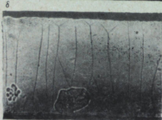
Рис. 3. а — доменная структура полоски после снятия постоянного поля по ОЛН; б — перестройка при действии обратного поля по ОЛН.
