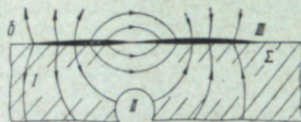
Рис. 3. I — поле дефекта и полярности созданных этим полем поверхностных зарядов; II — поле одних лишь поверхностных зарядов.
