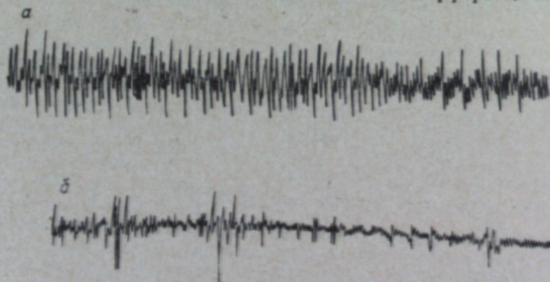
Рис. 5. Магнитограммы сварного шва:
