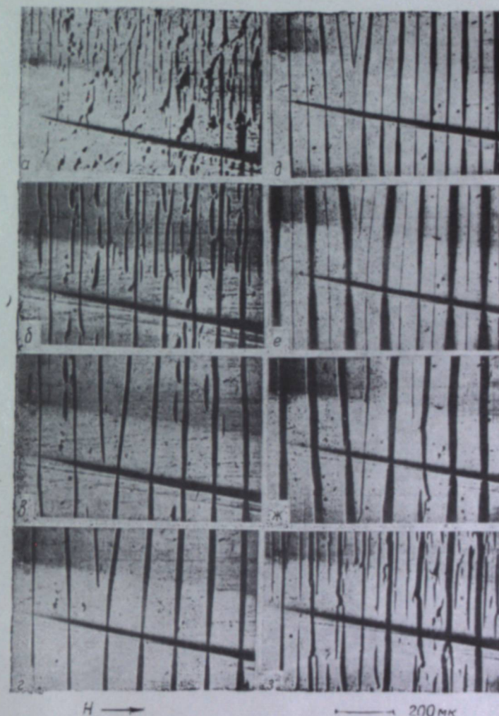
Рис. 4. Изменение порошковых фигур на плоскости, составляющей угол \alpha = 9^\circ с ОЛН в полях h , равных:
