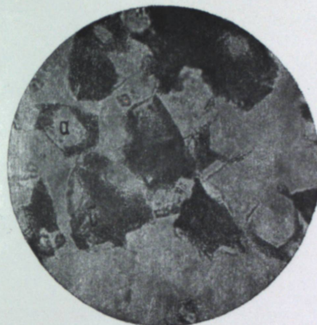
Рис. 2. Фото образца, полученного по реакции \text{Li}_2\text{O} \cdot \text{Al}_2\text{O}_3 + \text{CaO} , при t = 1250^\circ : а — алюминат лития; б — эвтектическая смесь.
