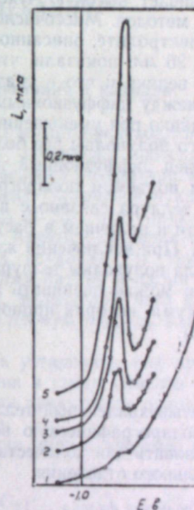
Рис. 5. Волны теллура в щелочном цианидном растворе в отсутствии поверхностно-активных веществ при различном содержании теллура.
