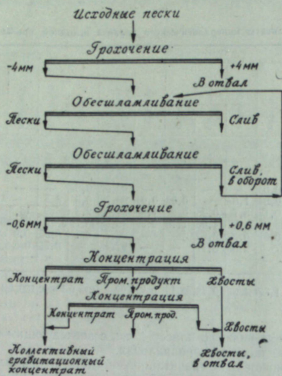
Рис. 1. Схема гравитационного обогащения песков с предварительным грохочением перед концентрацией.
