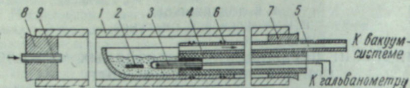
Рис. 1. Схема реакционного узла трубчатой печи.
