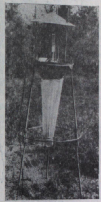
Рис. 1. Ультрафиолетовая ловушка конструкции Б. Г. Коврова.
