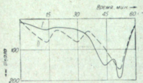
Рис. 1. Дегидратация ванадиевых квасцов (кривая I) и термическое разложение соединений включения ванадиевых квасцов с эфиром (кривая II).
