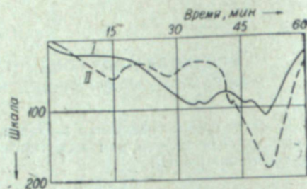
Рис. 2. Термическое разложение соединений включения ванадиевых квасцов со спиртом (кривая I) и бензолом (кривая II).
