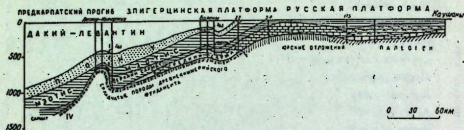
Рис. 1. Схематический профиль, иллюстрирующий условия залегания нефти и газа в неогеновых отложениях низовьев Припрудья.
