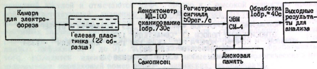
Рис. 1. Этапы автоматизированной обработки электрофоретических спектров.
