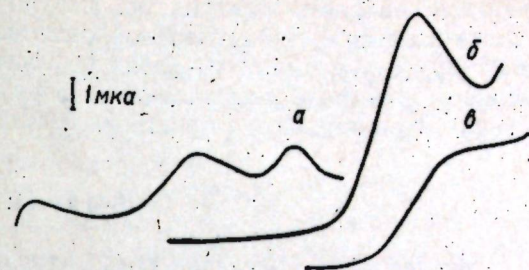
Рис. 1. Кривые D-галактуроновой кислоты ( 8 \cdot 10^{-4} моль/л, фон 0,1 н. KCl, pH 3,5): а — осциллополярограмма в присутствии растворенного кислорода; б — осциллополярограмма после удаления растворенного кислорода; в — полярограмма после удаления кислорода.
