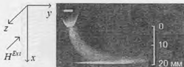
Рис. 6. Фотография стационарного режима дуги во внешнем поперечном магнитном поле H^{Ext} = 1,3 кА/м, I = 317 А, L = 20 мм, (Сердюк Г.Б.)
