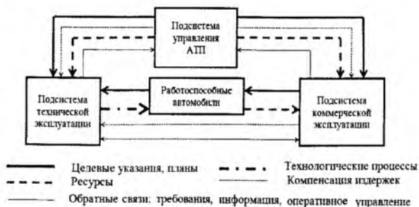
Рисунок 1 - Схема формирования технической эксплуатации как подсистемы автомобильного транспорта
