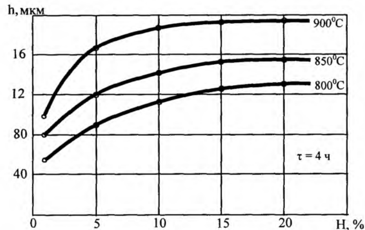
Рис. 7. Зависимость глубины диффузионного слоя от пористости напыленного покрытия
