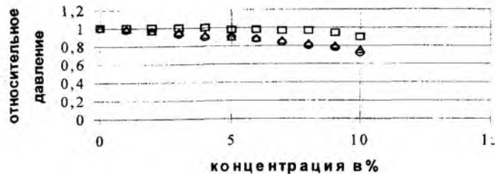
Рис.8. Зависимость P/P_0 от \phi при различных размерах воздушных пузырьков \square – d = 2 \div 3 мм, \Delta – 4 \div 5 мм, \circ – 5 \div 6 мм.
