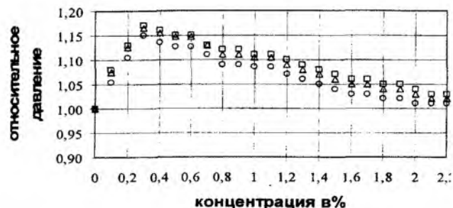
Рис.9. Зависимость относительного давления P/P_0 от концентрации \text{CO}_2 l = 6 мм, P_0 = 25 Н/м 2 , D = \square - 18 мм, \Delta - 25 мм, \circ - 51 мм
