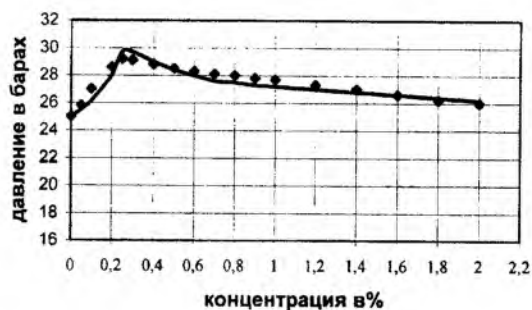
Рис.15. Зависимость амплитуды давления от степени газосодержания \text{CO}_2
