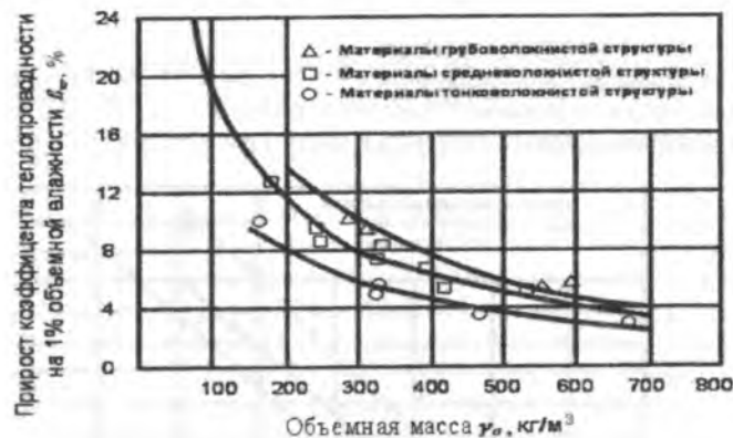
Рис. 9. Влияние влажности на теплопроводность органически связанных материалов волокнистого строения.
