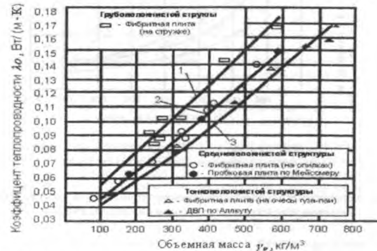
Рис. 8. Теплопроводность органически связанных материалов волокнистого строения в сухом состоянии. 1 - кривая для материалов грубоволокнистой структуры; 2 - то же, средневолокнистой структуры; 3 - то же, тонковолокнистой структуры.
