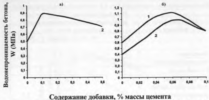
Рис. 2. Водонепроницаемость бетона состава 1:1,57:2,57:0,4 с и без МЛСТ (а) и бетона состава 1:1,3:2,33:0,38 с и без декстрина (б) в составе сульфатостойкого (1) и обычного (2) портландцементов
