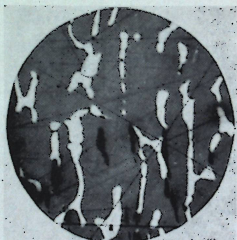
Рис. 8. Микроструктура сплава \text{InSb}\cdot\text{In}_2\text{Te}_3 после отжига при 450^\circ\text{C} в течение 2400 часов в атмосфере аргона ( \times 160 )
