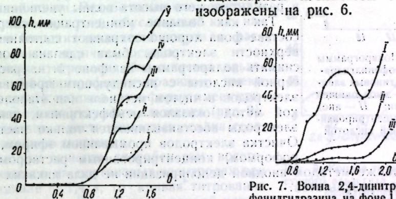
Рис. 6. Полярограммы восстановления 2,4-динитрофенилгидразина: I — фон; II — c = 0,0624 ммол/л; V — c = 2,56 ммол/л
