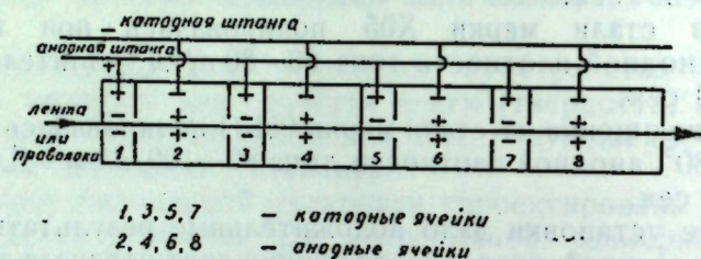
Рис. 2. Схема подвода тока к агрегату для скоростной электрополировки лент и проволоки по многоячейковому биполярному способу.
