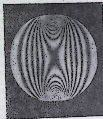
б) Замороженная картина полос сжатого диска из себациноэритритовой пластмассы. Краевой эффект достиг 0,5 полосы через пять суток хранения.
