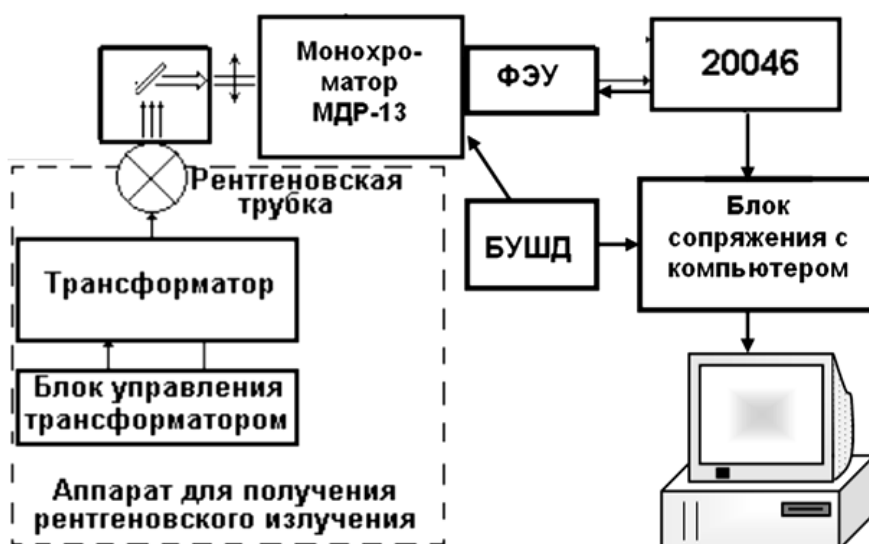
Рисунок 1 - Структурная схема экспериментальной установки для измерения спектров рентгенолюминесценции.
