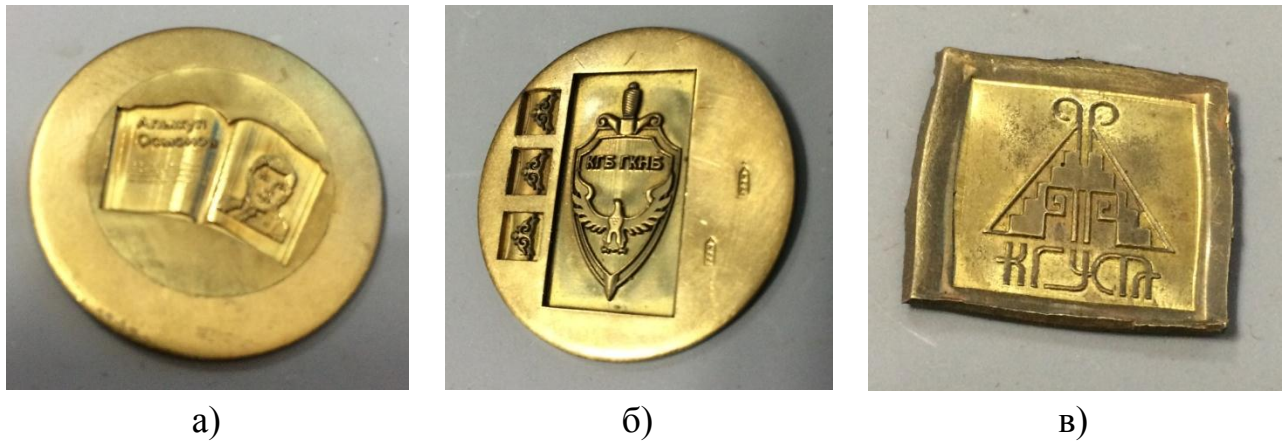
Рис. 4.1. Примеры лазерного формирования рельефа: 3D-гравировка на изделиях (а, б). Тиснение рельефа с помощью штампа (в), латунь Л63
