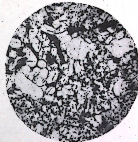
Рис. 2. Клинкер Т-1, неравномернозернистая структура, алит и браунмиллерит. \times 160 .
